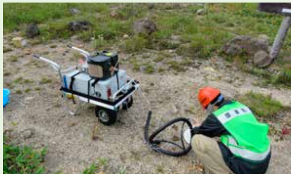
湯釜火口内での地中ガスの採取と測定。
