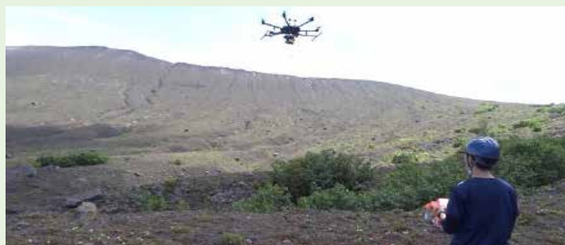
特殊なガス採取装置を吊り下げて離陸する東京工業大学の大型ドローン。ふだんは草津白根山において運用されています。
