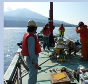
(左) 海底電位磁力計の投入の様子。(右) 海底電位磁力計の投入直前の船上作業の様子。背景は噴煙を上げる桜島昭和火口。
