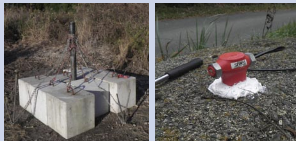
(左) 阿蘇火山高岳中腹の発破孔。深さ 20m まで掘削した孔の底に爆薬が装填される。(右) 阿蘇市内の道路脇に設置した小型地震計。
